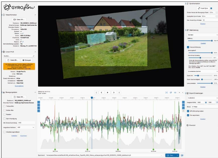
**4** Gyroflow nutzt die auf dem Smartphone aufgezeichneten Daten des Gyroskop-sensors (Kurven unten), um Kamerabewegungen herauszurechnen.
